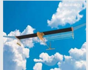
Ce type de propulsion consiste à utiliser un champ électrique pour accélérer des ions (particules chargées) qui entrent en collision avec l'air, créant un «vent» qui fait avancer l'avion. Silencieux, cet avion est paré de vertus: ses pièces mécaniques n'ont pas à être mobiles, il n'est pas équipé d'un moteur à combustion. Il ne consomme donc pas de carburant et ne produit pas d'émissions polluantes. Un bel avenir lui semble promis si les scientifiques parviennent à transformer l'es-
